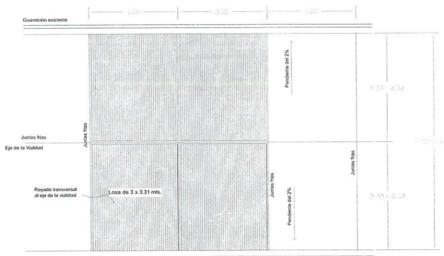
ESQUEMA DE DISTRIBUCIÓN DE LAS LOSAS DE PAVIMENTO
